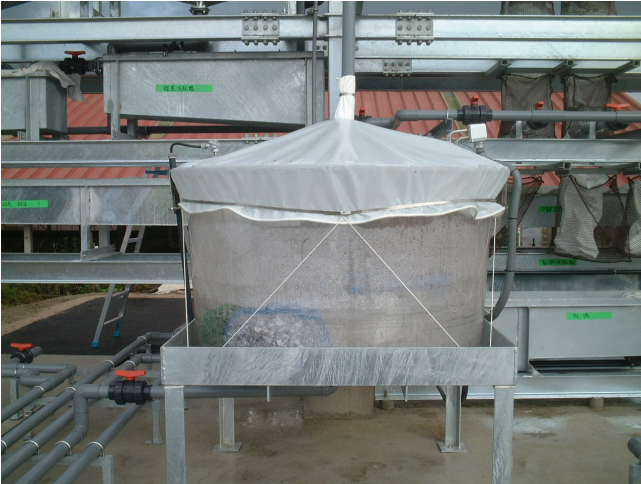
太陽熱醗酵腐熟槽
